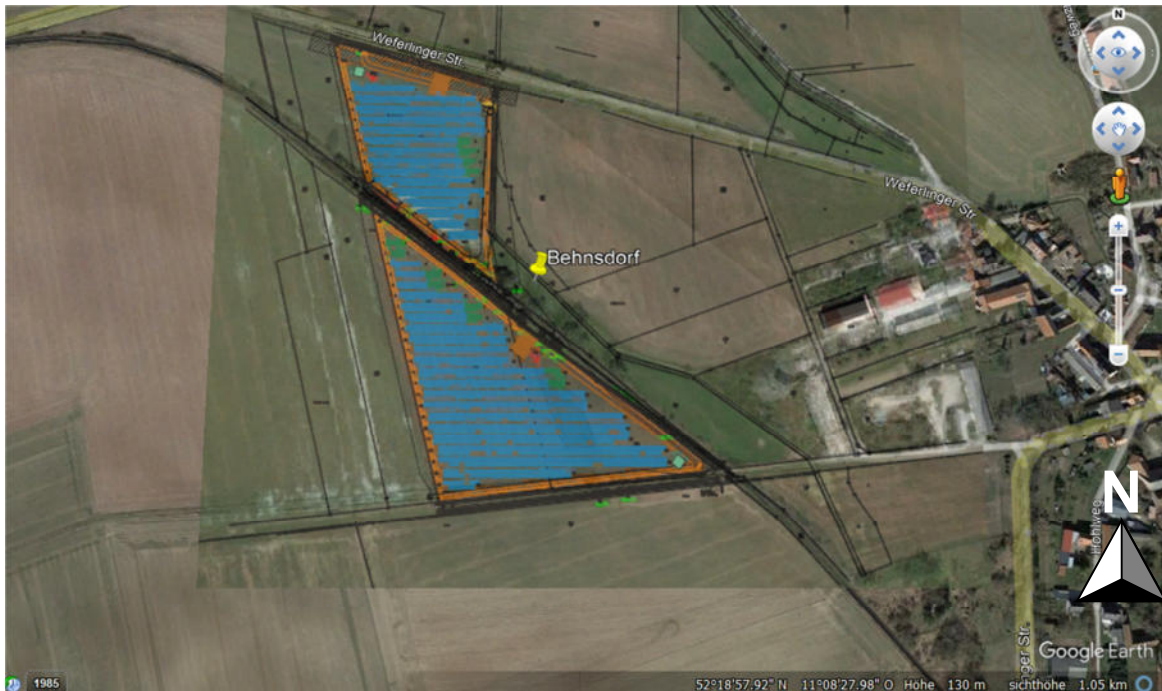
Abbildung 1: Satellitenbild mit eingebettetem Modulbelegungsplan des Anlagenstandortes [Quelle: GoogleEarth, Modulbelegungsplan vom Kunden zur Verfügung gestellt]
